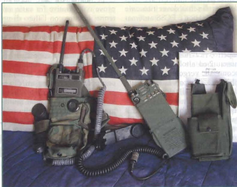
L'AN/PRC-128 è un transceiver leggero, dotato di due vie di comunicazione a voce. Esso è composto di tre parti principali:
